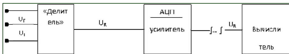
Рисунок 6.3 . Схема подключения аппаратного делителя к схеме определения значений импеданса биотканей Z_{бт} .
